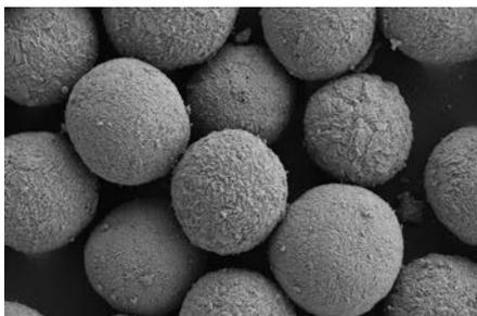
Mit Powder-Up! erweitert das ZSW seine Möglichkeiten zur Synthese von Batteriematerialien bis in den 100-Kilogramm-Maßstab. Das Bild zeigt eine rasterelektronenmikroskopische Aufnahme der Partikel eines koblaltfreien Kathodenmaterials, hergestellt am ZSW.
