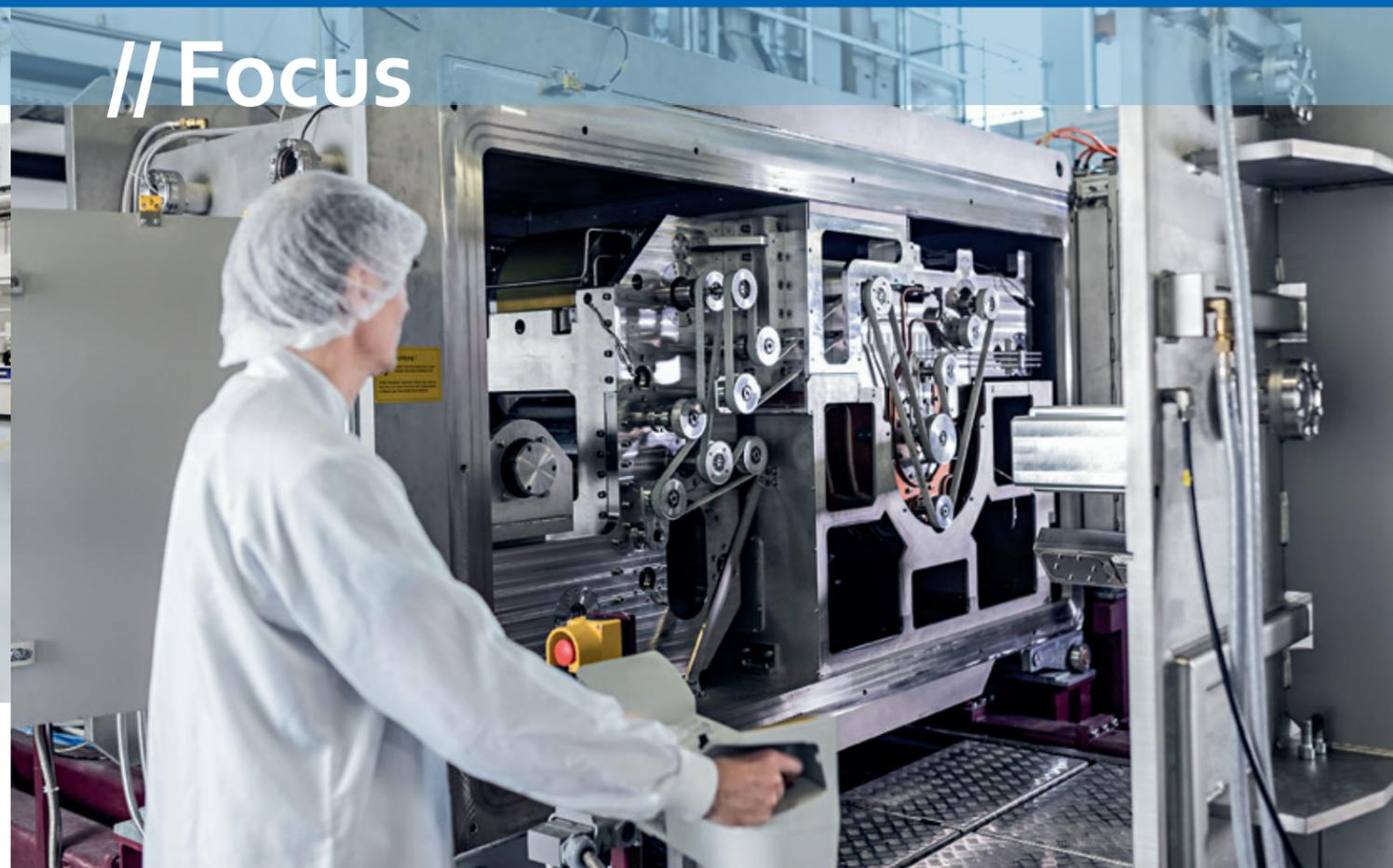
// Anlage zur Rolle-zu-Rolle-Beschichtung von flexiblen Substraten am ZSW.
