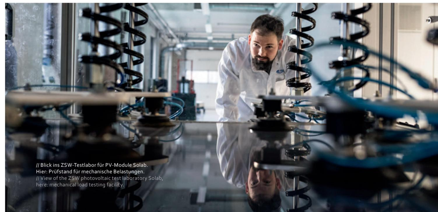
// Blick ins ZSW-Testlabor für PV-Module Solab. Hier: Prüfstand für mechanische Belastungen.
