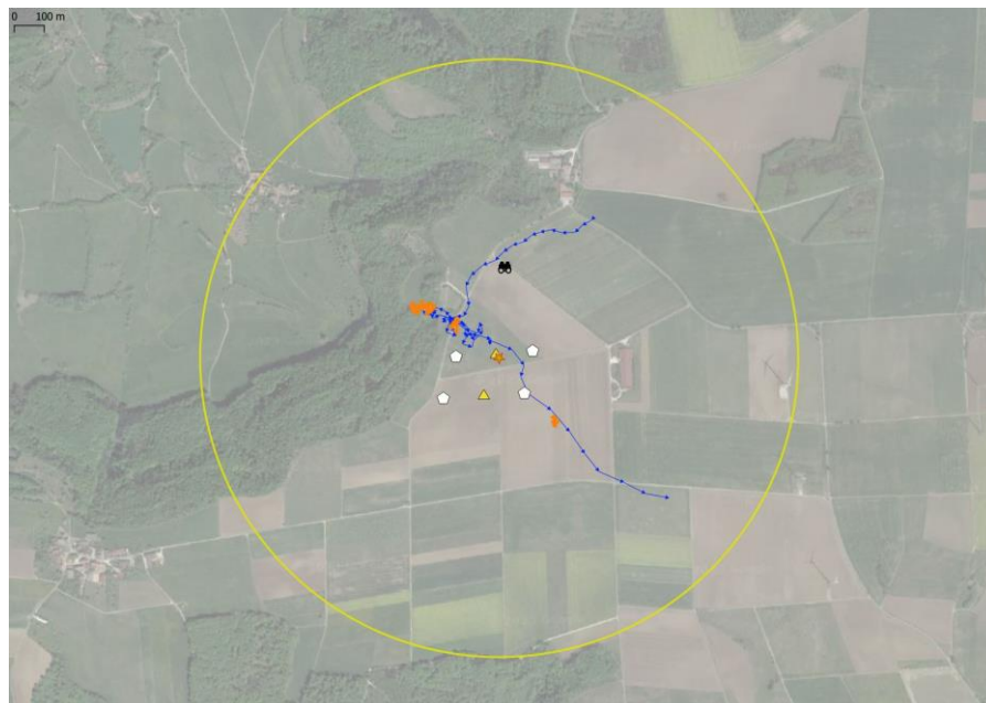
Abb. 13 Abgleich eines GPS-Flugwegs mit den BirdRecorder-Daten. Die Erfassung durch den BirdRecorder fällt bruchstückhaft aus.
