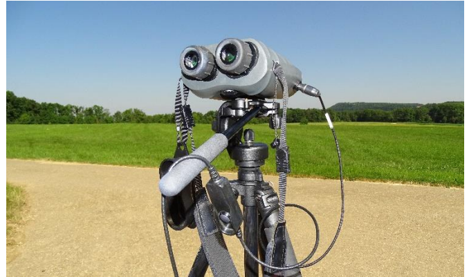
Abb. 8 Laser-Range-Finder Vector21 Aero (J. Aschwanden, 09.07.2019)
