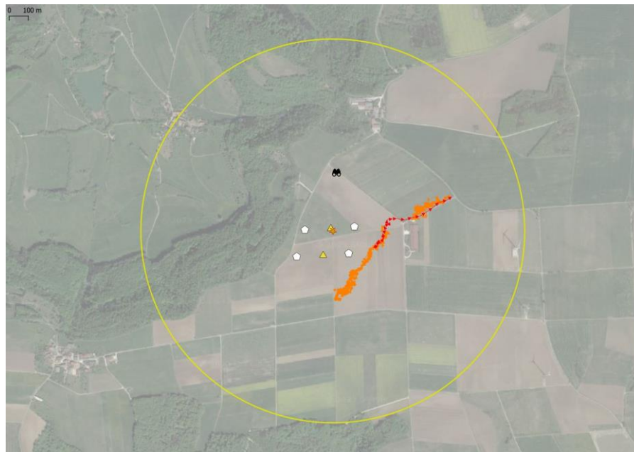
Abb. 12 Abgleich eines LRF-Flugwegs mit den BirdRecorder-Daten. Die unbeständige Distanzbestimmung verwischt die Geradlinigkeit des BirdRecorder-Flugwegs.
