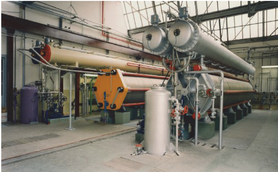
Abb. 2: 2 alkalische Druckelektrolyseanlagen nach dem Lurgi-Prinzip; Quelle: ELT; www.elektrolyse.de
