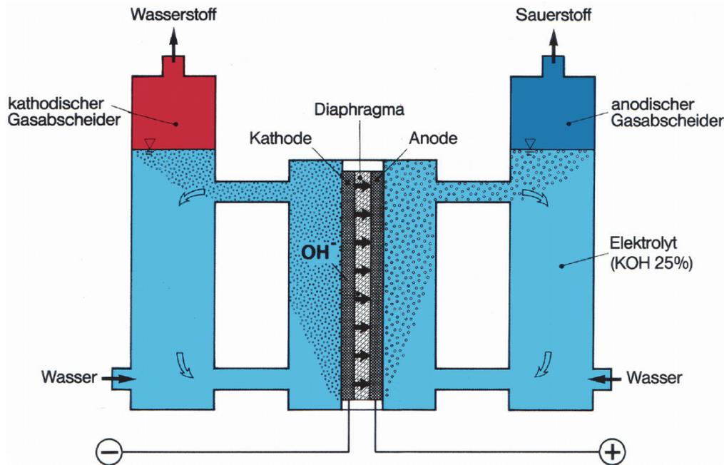
Schema der alkalischen Elektrolysezelle
