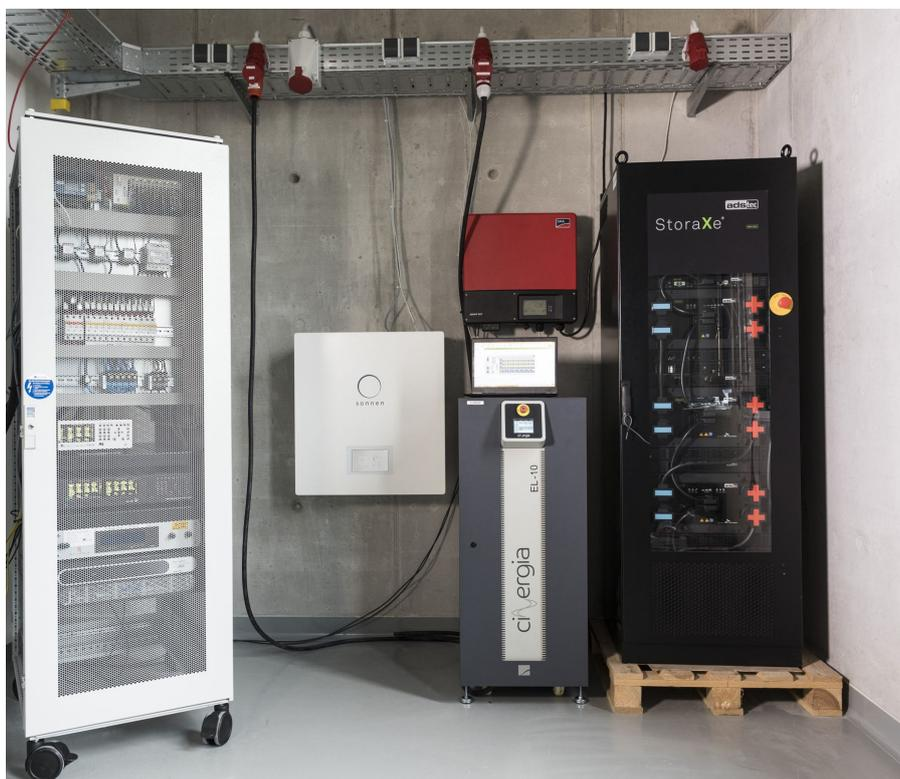
**Abbildung 2.24.** – Laboraufbau des ZSW zur Simulation eines Netzanschlusspunkts für den **HIL**-Test mit den Speicherbatterien der Firma Sonnen (weiß) und ads-tec (schwarz, Aufschrift StoraXe), sowie dem Lastgenerator (grau) und dem Wechselrichter (rot). Links im Rack befinden sich oben die Anschlussfelder mit diversen Strom- und Spannungsmessklemmen sowie der **SPS** von WAGO, darunter der Netzanalysator, der PV-Simulator und der Netzsimulator.
