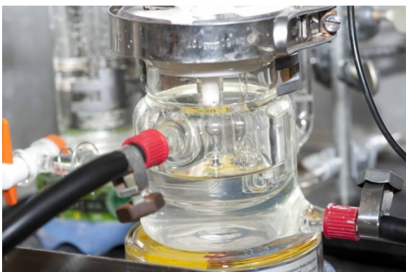
Symbolbild Uni Ulm (Foto: Elvira Eberhardt/Uni Ulm): Einblick in die Elektrochemie-Forschung: Mit dem Drei-Elektrodenaufbau lassen sich Prozesse an der Elektrode oder an Elektrolyt-Grenzschichten auflösen
