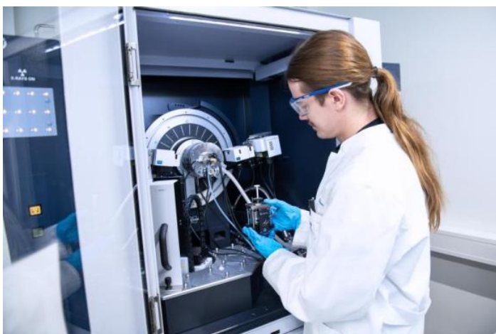
Powder-Up-Analytik für Kathodenmaterialien: SEM/FIB-SEM, EDX, Raman, AFM, RFA und XRD; In-situ-XRD (im Bild) ermöglicht die Analyse von Phasenübergängen und Kristallstrukturänderungen.
