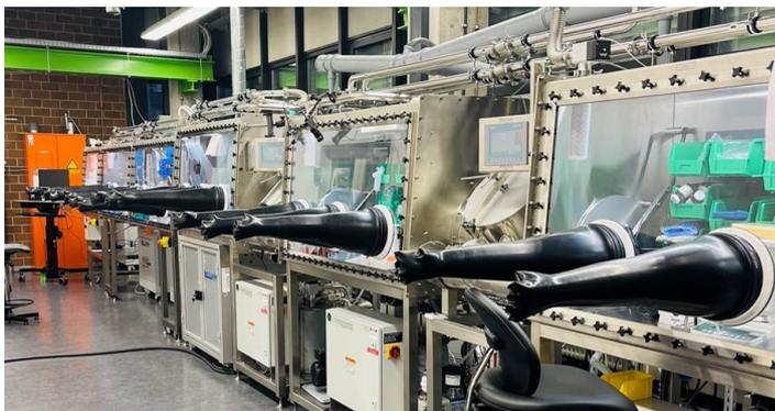
Glovebox-Array: Forschungsanlage zur Entwicklung innovativer Perowskit-Dünnschicht-Halbleitermaterialien für Solarzellen. Foto: Claudiu Mortan, Universität Stuttgart.
