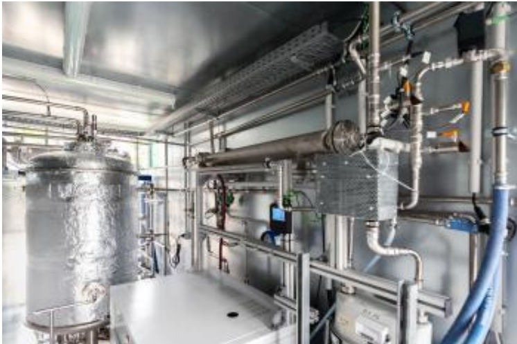
CO 2 -Desorber zur Regenerierung des Sorbens
