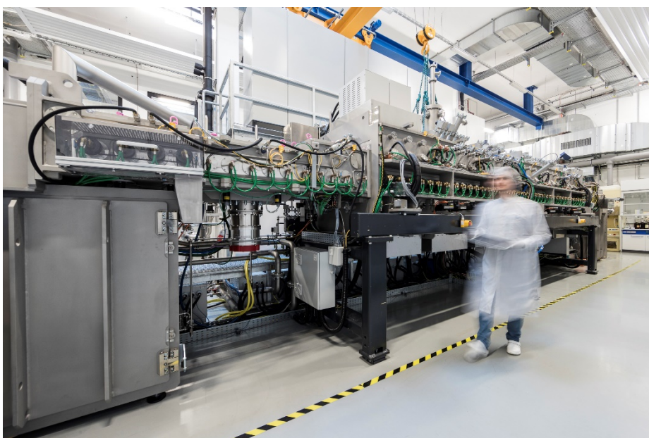
Ein Mitarbeiter des ZSW an der CIS4 Beschichtungsanlage
