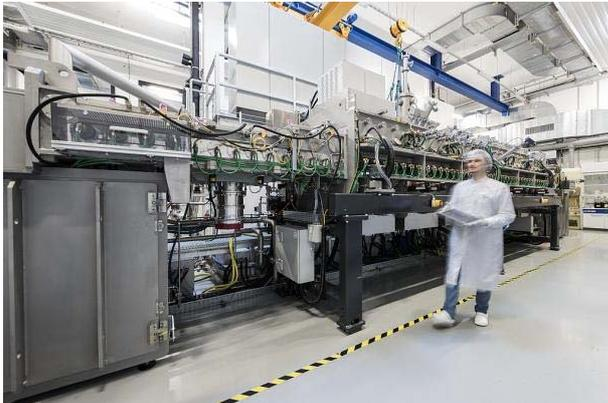
Anlage zur Abscheidung der CIGS-Schicht mit dem Verfahren der Koverdampfung.
