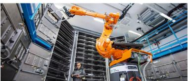
Das ZSW betreibt seit 2014 eine europaweit einzigartige Forschungsplattform für die industrielle Produktion von großen Lithium-Ionen-Zellen im PHEV-1-Format (FPL) - Blick in die vollautomatische Assemblierung und Formierung. Mit ZellkoBatt werden die Anlagen erweitert.
