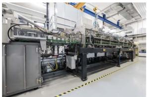
Künstliche Intelligenz und maschinelles Lernen können künftig auch die Herstellung von CIGS-Solarmodulen optimieren. ZSW-Forscher an Beschichtungsanlage für CIGS-Dünnschicht-Solarmodule.
