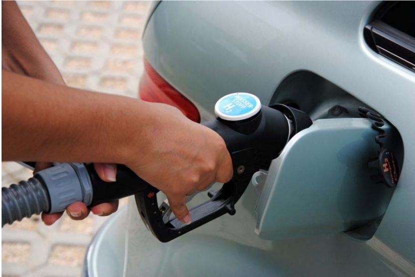
Betankung eines Brennstoffzellenautos mit Wasserstoff.
