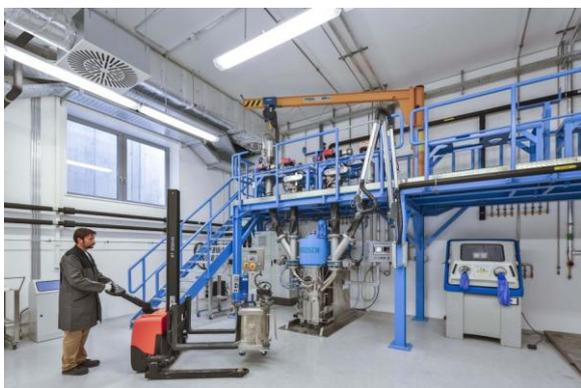
60-Liter Mischstation zum Anfertigen der Elektrodenpasten. Foto: ZSW/Duckek
