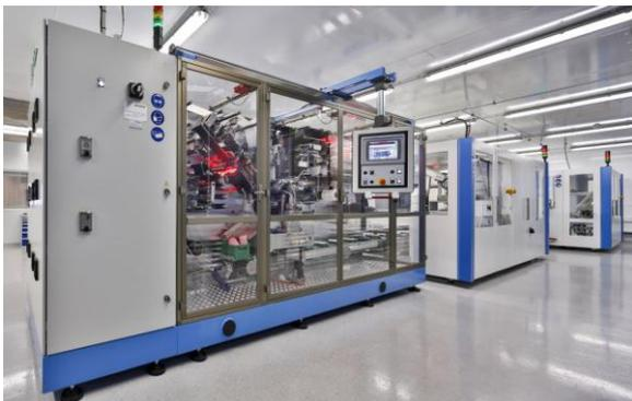
Trockenraum mit 200 Quadratmetern Fläche zur vollautomatischen Zellaufbauung. Foto: ZSW/Duckek
