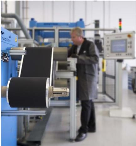
Elektrode fertig zum Kalandrieren. Foto: ZSW/Duckek
