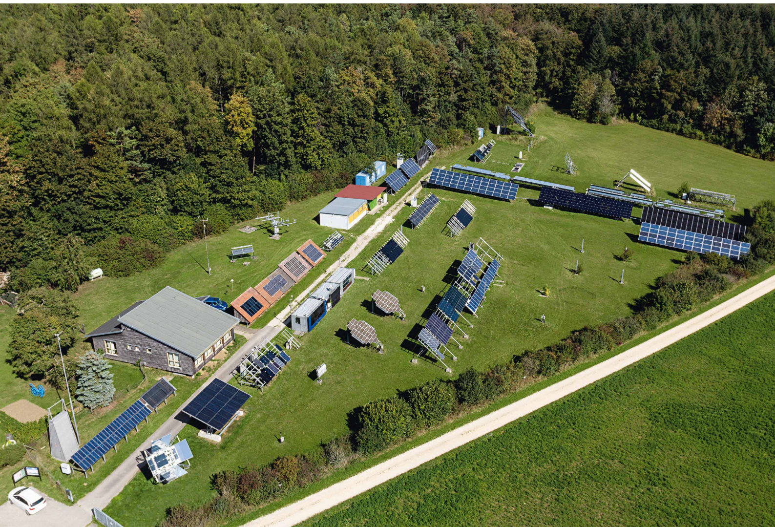
Die Wissenschaftler des ZSW vergleichen PID-Tests mit Freilanderfahrungen vom Testgelände in Widderstall. Die Leistung eines PID-anfälligen Moduls würde nach den Ergebnissen in 20 Jahren auf die Hälfte fallen, obwohl es den Standardtest bestanden hat.
