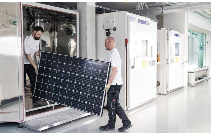
Module in Klimakammern auf PID-Anfälligkeit zu testen, ist aufwendig und teuer. Untersuchungen am Zentrum für Sonnenenergie- und Wasserstoff-Forschung zeigen nun, dass die Ergebnisse bei hohen Spannungen für 1.500-Volt-Anlagen irreführend sein können.
