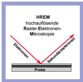
Die Rasterelektronenmikroskopie ist ein klassisches Verfahren zur Abbildung der Topographie von Oberflächen. Diese werden mit einem fokussierten Elektronenstrahl zeilenförmig abgerastert und mit Hilfe der emittierten Elektronen auf einem Monitor abgebildet. Im Vergleich zu einem konventionellen Lichtmikroskop lassen sich wesentlich höhere Vergrößerungen und Tiefenschärfen erzielen.
