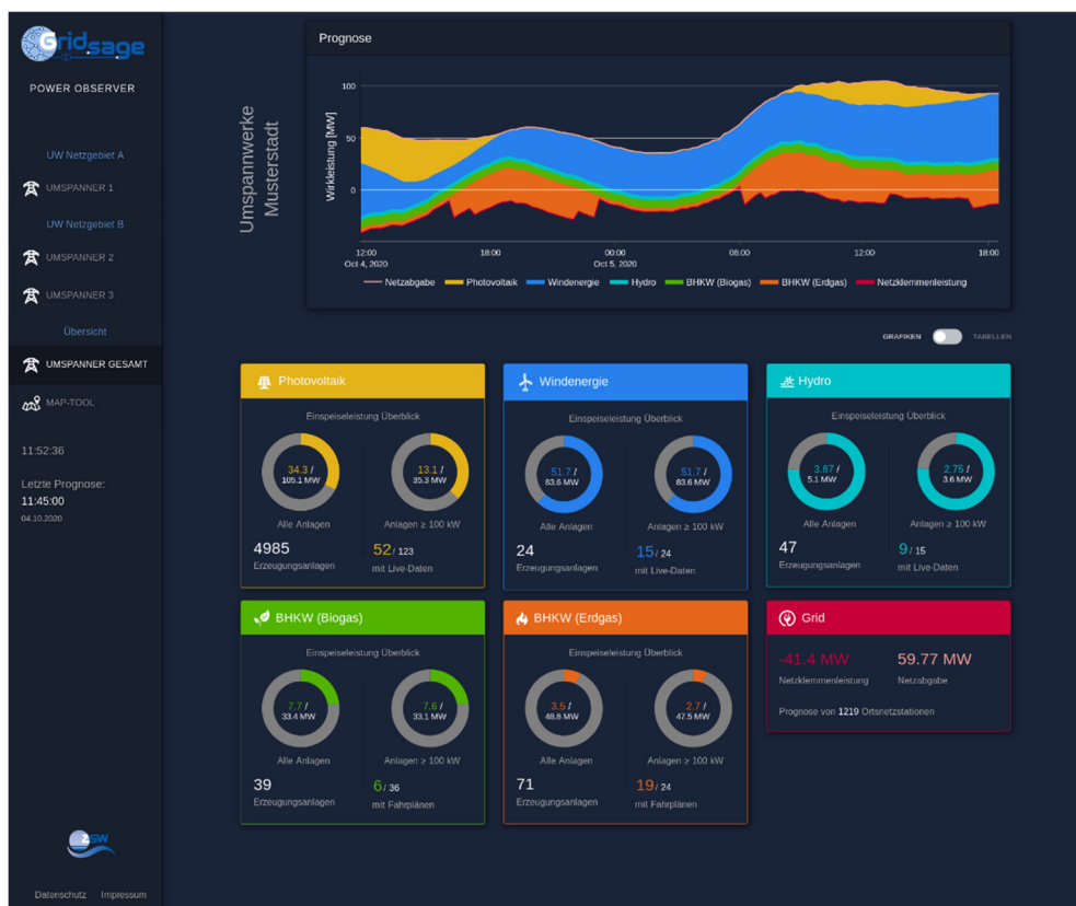
Abbildung 1: Power Observer: Interaktives Dashboard zur Überwachung der aktuellen Einspeisung und Last im Netz. Die aktuelle Prognose, getrennt nach Umspannwerken und in Summe, sowie die aktuelle Einspeisung nach Energieträger (sowohl Redispatch 2.0-Anlagen als auch alle Anlagen) werden angezeigt, ebenso die Anzahl der Anlagen, die gegenwärtig Live-Daten liefern – die Übergabe zum überlagerten Netz auf einen Blick.
