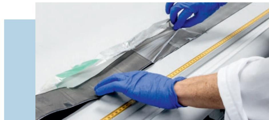
// Professionelle Zellöffnungen und Post-mortem-Analysen ermöglichen es, Schädigungsmechanismen an Batterien zu identifizieren.
