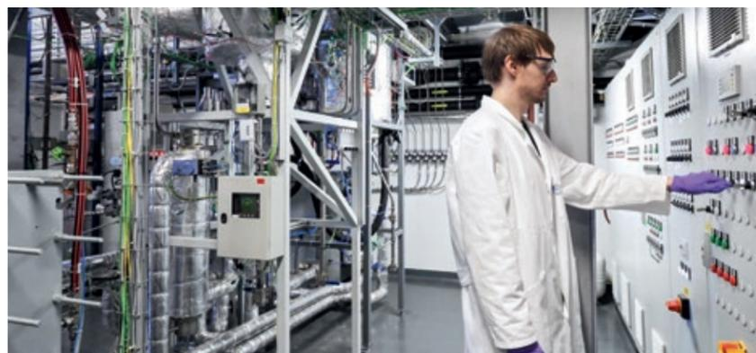
// 15-kW<sub>th</sub>-Wirbelschicht-Technikumsanlage im Versuchsbetrieb zum Phosphor-Recycling aus Klärschlamm.
