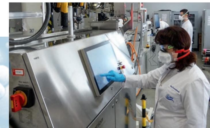
// Forschungsanlage, um Elektroden in einem Schritt trocken zu extrudieren, prozessieren und in der Zelle weiterzuverarbeiten.
