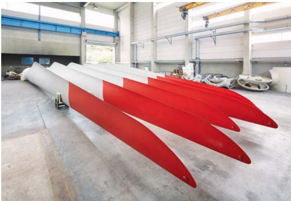
Überarbeitete und mit Sensoren ausgerüstete Rotorblätter.
