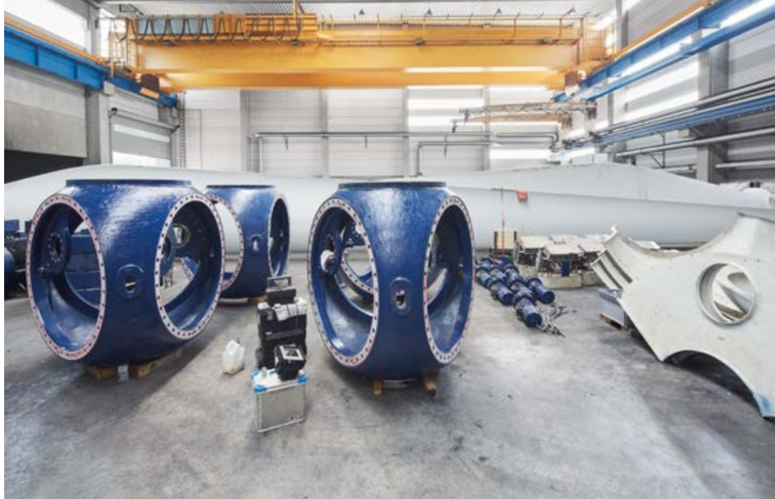
Ultraschallprüfung der Gussnaben in der Montagehalle in Königsbronn.
