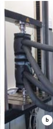
a) Messstand und b) Messapparatur zur Wärmeleitfähigkeits- messung im unisolier- ten und isolierten Zustand.
