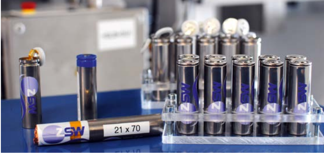
Batterieprototypen im 21700-Format mit wässrig beschichteten nickelreichen Kathoden.
