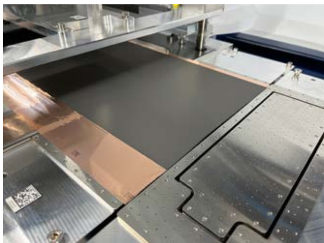
Laservereinzeln von Elektrodenblättern für die Herstellung von großen Lithium-Ionen-Zellen.
