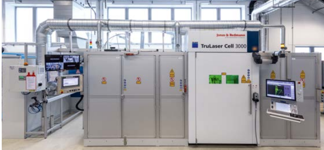
Laser-Schneideanlage zur formatflexiblen Elektrodenfertigung.
