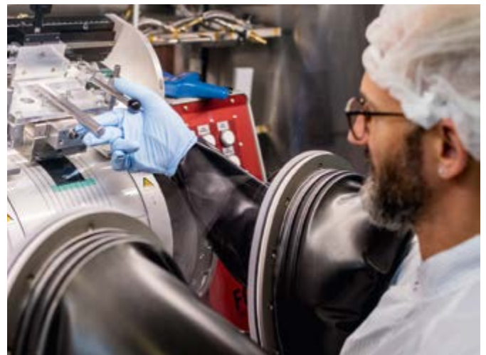
Herstellung flexibler Perowskitesolarzellen mittels Schlitzdüsenabscheidung. Production of flexible perovskite solar cells using slot die coating.
