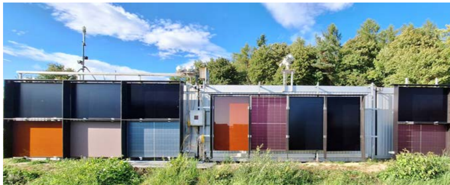
Fassaden-PV-Teststand zur Untersuchung des Einflusses von dynamischen Teilverschattungssituationen auf die Langzeitstabilität verschiedener Modultechnologien.
