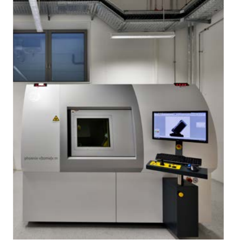
^ 3D-CT für die zerstörungsfreie Analyse interner (Batterie-) Zellstrukturen.
