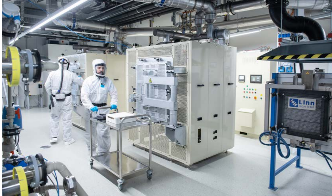
Powder-Up!-Spezialausstattung: Hochtemperatur-Kalzination im RHK8-Ofen zur Verarbeitung von bis zu 5 kg Material pro Probe.
