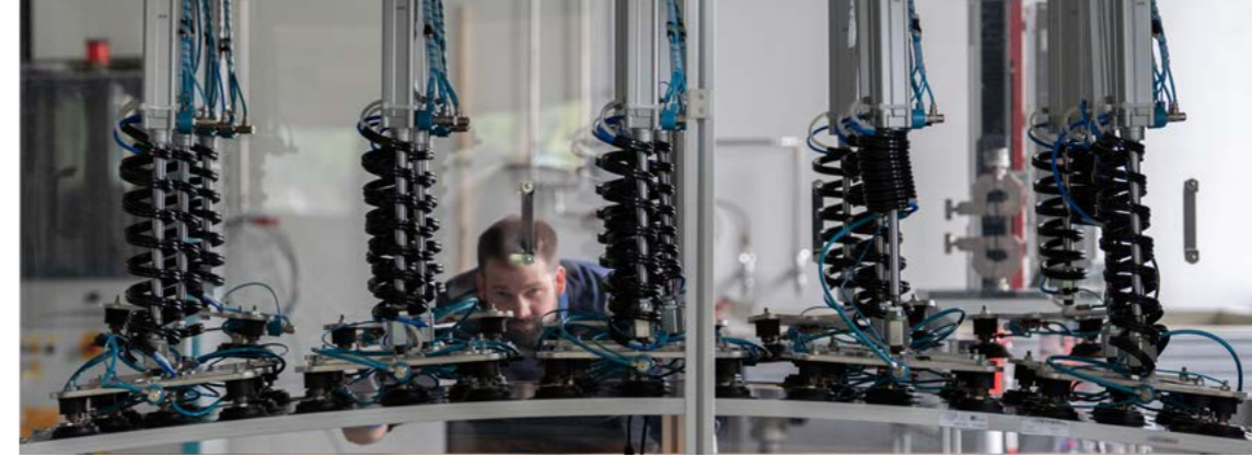
Mechanischer Belastungstest an PV-Modulen im ZSW Solab.
