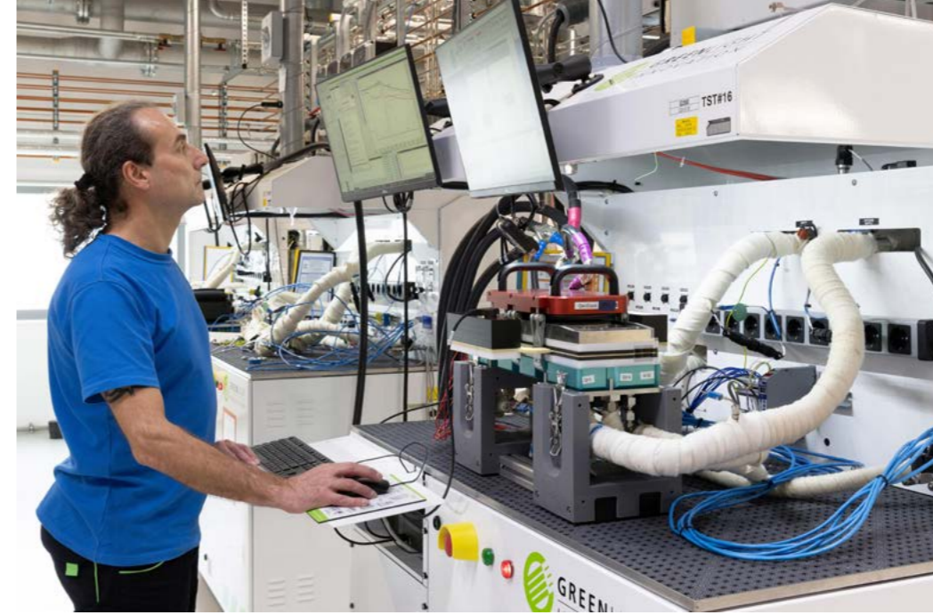
Skalierbarer, generischer Brennstoffzellenstack für Entwicklungen im Stack- und Systembereich im Teststand (als Kurzstack).
