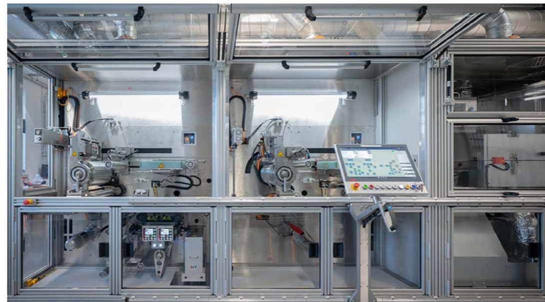
Rolle-zu-Rolle (R2R)-Beschichtungsanlage für flexible Perowskit-Module.
