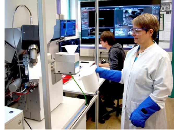
< FIB-SEM-Analytik im Ulmer Labor: Hochauflösende Material- und Oberflächenanalyse mit fokussiertem Ionen- und Elektronenstrahl.
