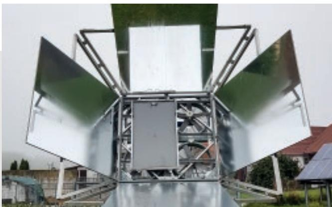
// Untersuchung der Beständigkeit einer reparierten Modul-Rückseitenfolie unter konzentrierter Einstrahlung auf dem Solar-Testfeld Widderstall.
