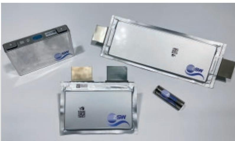
// Neue Zellformate am ZSWL: Pouch- und PHEV-2-Zellen bis 80 Amperestunden sowie 21700-Rundzellen.
