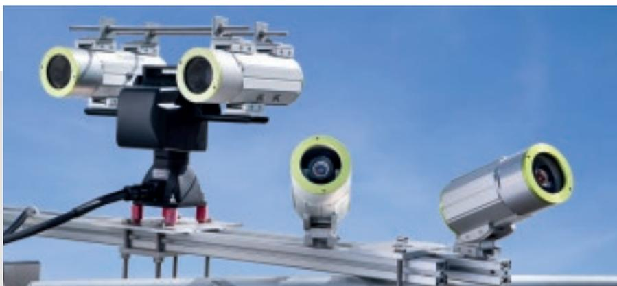
// Hightech für Artenschutz und Windenergie: der vom ZSW entwickelte BirdRecorder.
