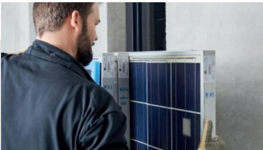
// Ein ZSW-Mitarbeiter inspiziert feldgealterte PV-Module mit beschädigten Rückseitenfolien.
