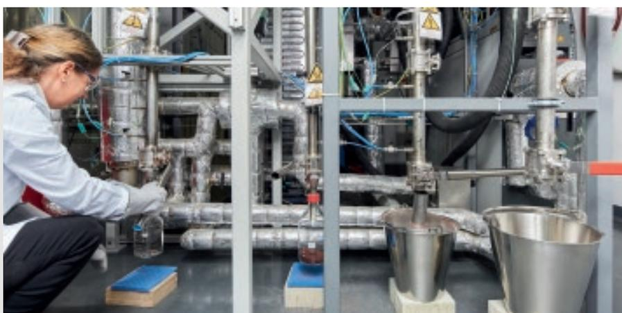
// Die Wirbelschichtversuchsanlage am ZSW.
