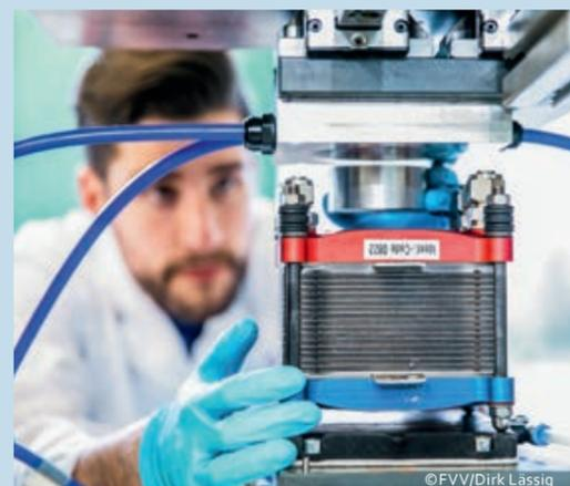
// Blick ins Brennstoffzellentestzentrum. Aktuell fahren 25 vollautomatische Teststände im Rund-um-die-Uhr-Betrieb.
