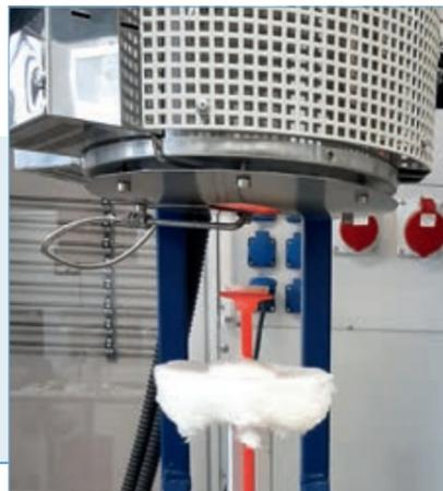
// Kontrollierte Verbrennung von Klärschlamm im Zweizonen-Rohröfen.
