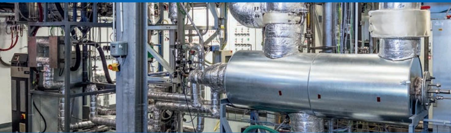
// Die 10-kW<sub>th</sub>-Wirbelschichtanlage des ZSW mit Heißgas-Partikelabtrennung.
