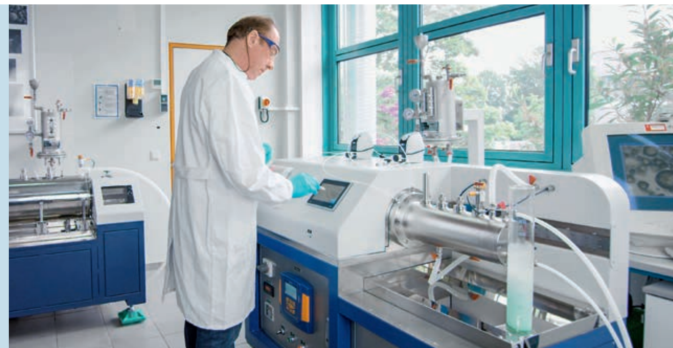
// Synthesereaktoren am ZSW zur Herstellung von bis zu 30 Kilogramm Aktivmaterial. // New synthesis reactors at ZSW for producing up to 30 kilograms of active material.
