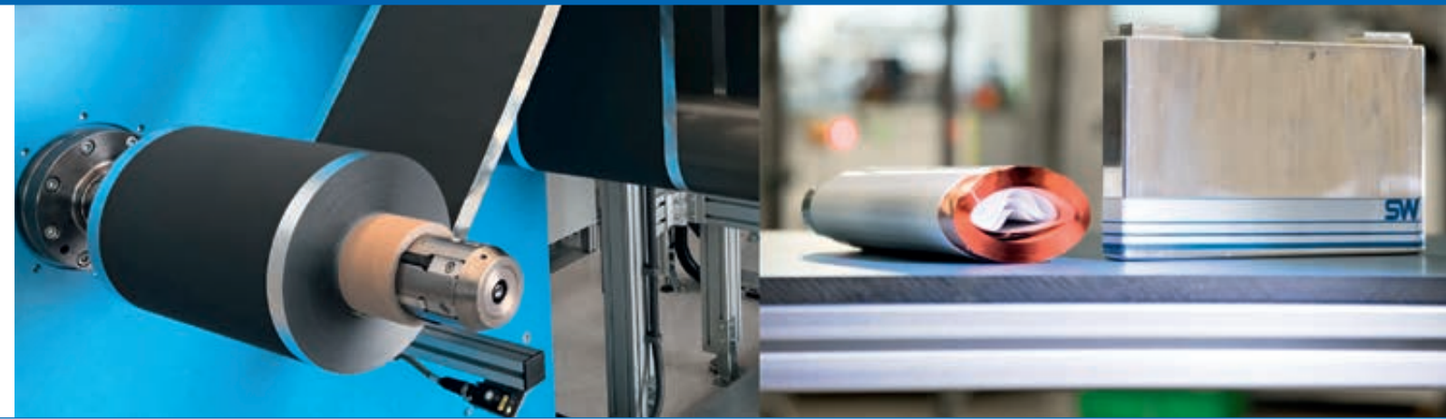
// 400-m-Kathodenband (links) und prismatische PHEV-1-Zelle mit Aluminiumgehäuse (Hardcase) und Flachwickel (rechts), hergestellt an der FPL des ZSW. // 400-m cathode band (left) and prismatic PHEV-1 cell with aluminium housing (hard case) and flat winding (right), manufactured on ZSW's FPL.
