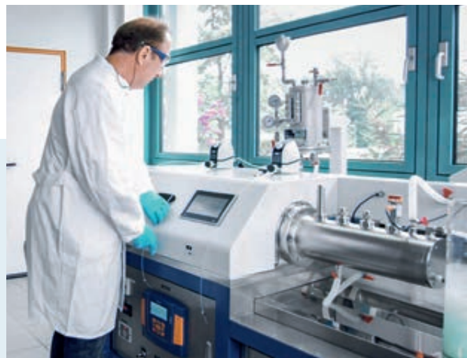
// Synthesereaktor für Fällungen bis in den 10-kg-Maßstab. // Synthesis reactor for precipitation to 10 kg scale.
