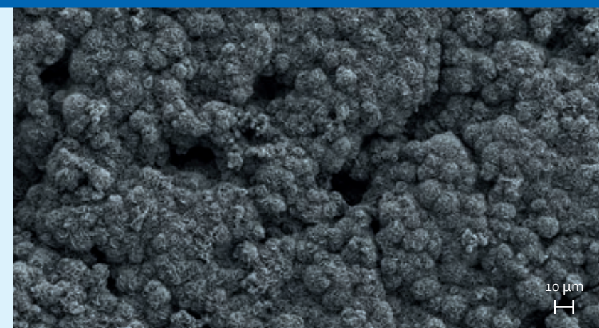
// Rasterelektronenmikroskopische Aufnahme einer 5-μm-MnO 2 -Schicht auf nano-strukturierten Nিকেlelektroden. // Scanning electron microscope image of a 5-μm-MnO 2 layer on nanostructured nickel electrodes.
