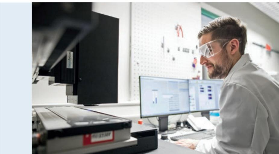
// Qualitätssicherung der Gasverteilerstrukturen mittels Weißlichtinterferometer.
