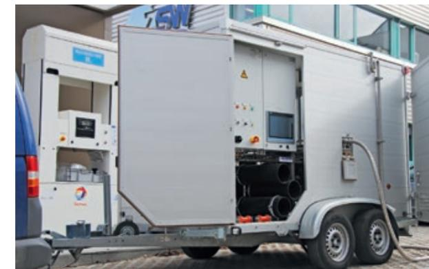
// Neues Messsystem zur Abnahme von H<sub>2</sub>-Tankstellen nach der Richtlinie SAE J2601.
