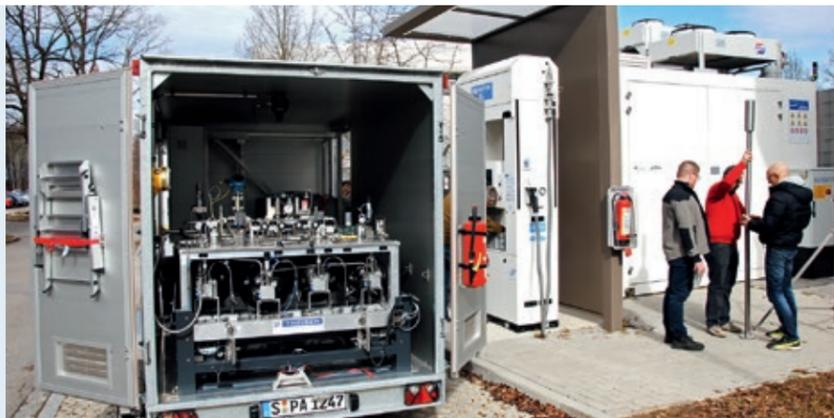
// Mobiles Messsystem zur Abnahme von H<sub>2</sub>-Tankstellen.
