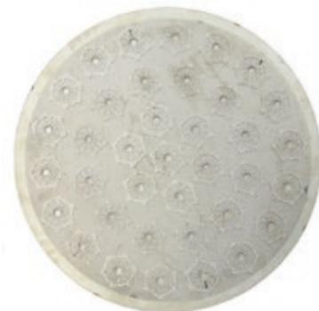
// Elektrodenpackage mit katalytisch aktiver Kathodenbeschichtung.
