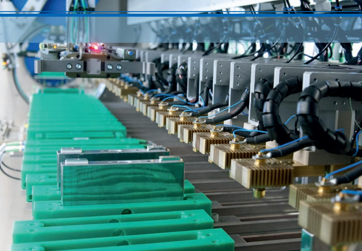
// Forschungsplattform zur Produktion von Lithium-Ionen-Zellen: Anlage zum Vorformieren prismatischer Wickelzellen (PHEV-1-Format).
