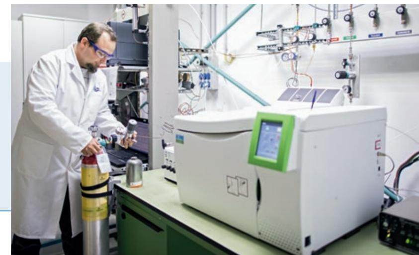
// Neue Laborausstattung zur Analyse von Wasserstoffproben nach SAE J2719/ISO 14687-2.
