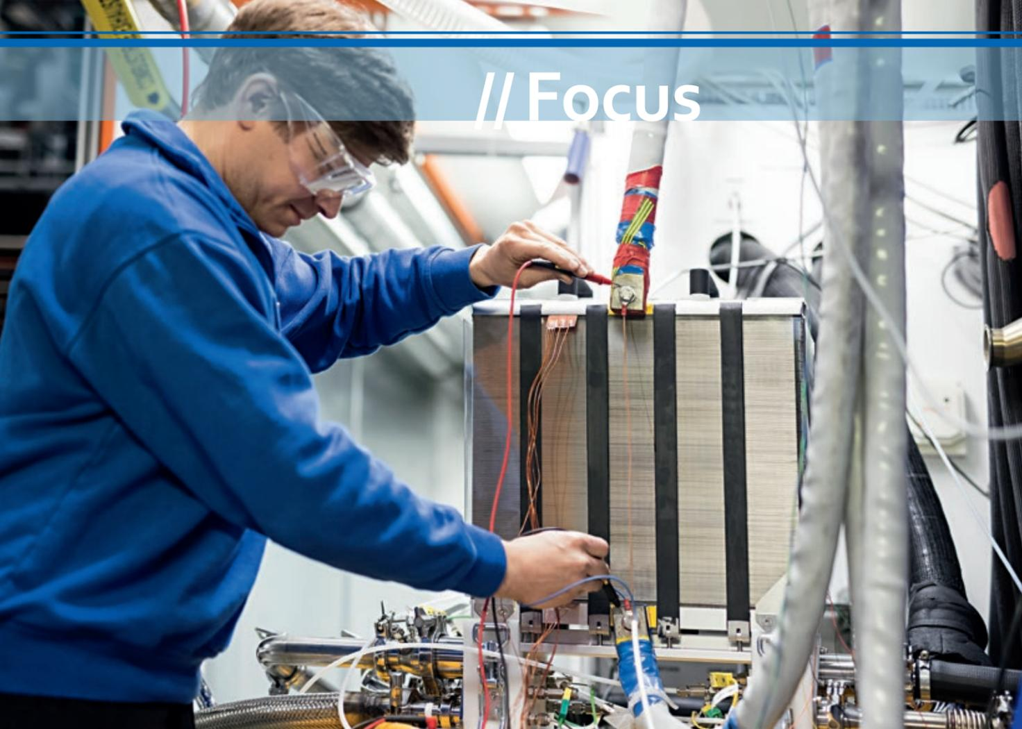
// Fahrzeugtaugliche Hochleistungsbrennstoffzelle mit 100-kW-Dauerleistung im ZSW-Teststand.
