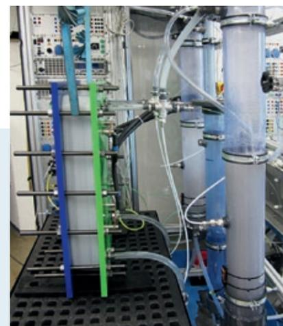
// Neu entwickelter ecoPtG-Short-Stack im Versuchsbetrieb im ZSW-Labor.
