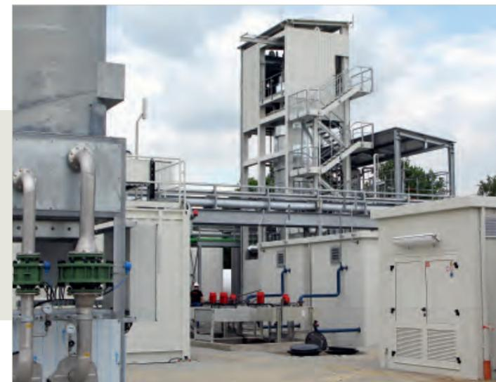
// Methanisierung der e-gas-Anlage in Werlte.
