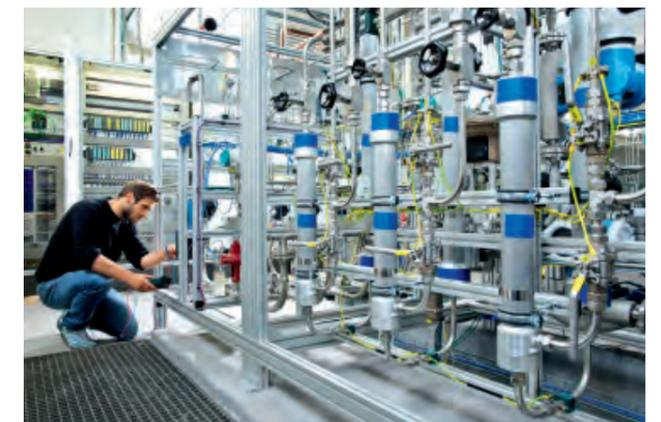
// Bei der Gasaufbereitung kommt eine am ZSW entwickelte Membrantechnologie zum Einsatz.
