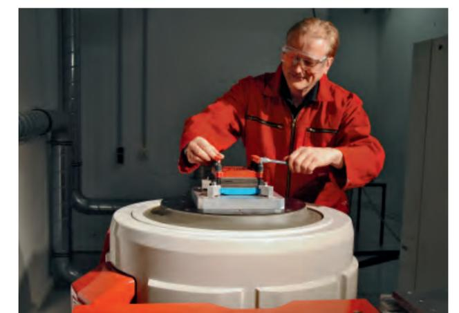
// Shaker für mechanischen Belastungstest von Batterien und Brennstoffzellen im Testzentrum.
