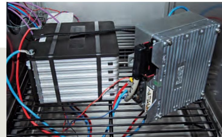
// Batteriemangementsystem mit laufzeitoptimierter Applikationssoftware zur Zustandsbestimmung für 2 Stränge mit je 9 Modulen à 14 Zellen.
