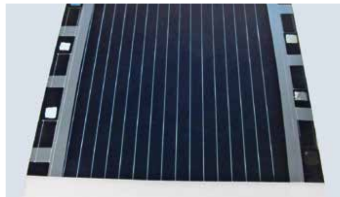
// CIGS-Modul mit 16,8 % Wirkungsgrad aus der Inline-Technikumslinie des ZSW. // CIGS module with a 16.8% efficiency from the inline technical lab line at ZSW.
