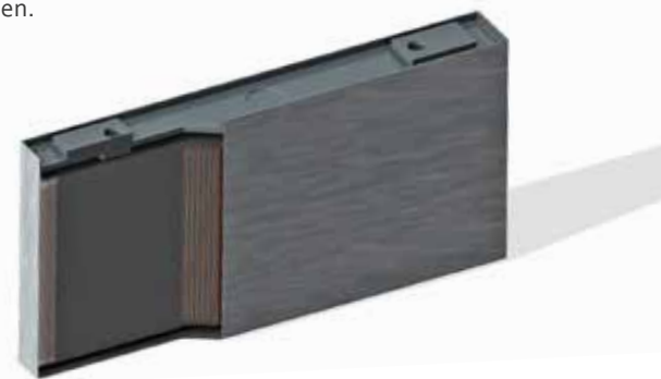
// Basistechnologie für den „Leitanbieter Elektromobilität“. ZSW-CAD-Konstruktion prismatische Wickelzelle nach VDA-Kriterien (PHEV-1-Design nach VDA). // Enabling technology for Germany as the leading electromobility provider. ZSW CAD construction of a prismatic coil cell according to VDA criteria (PHEV 1 design according to VDA).
