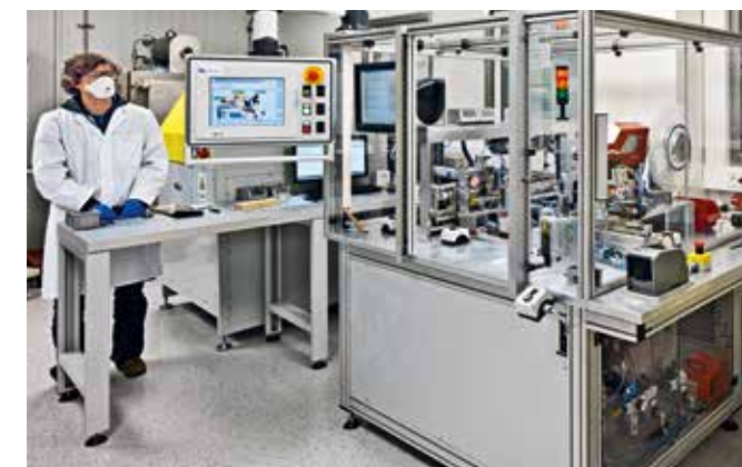
// 40 m 2 Trockenraum mit Stapelmaschine für Pouchzellen. // 40 m 2 drying room with a stacking machine for pouch cells.
