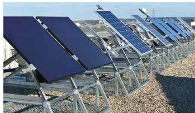
// Modulteststand des ZSW auf dem spanischen Testfeld Girona, das auch zum Monitoring von Tandemmodulen dient. // ZSW's module testing facility at the Girona test field in Spain, which is also used for monitoring tandem modules.
