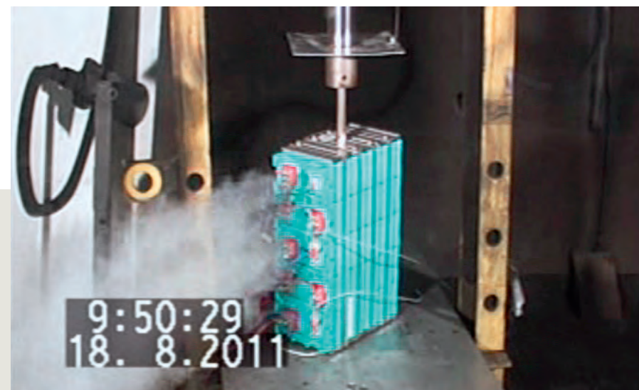
// Rauchemission bei Nagel-Penetrationstest für ein Lithium-Zellen-Modul für die EV-Applikation. // Smoke emission during nail penetration test for a Li-cell-module for EV application.
