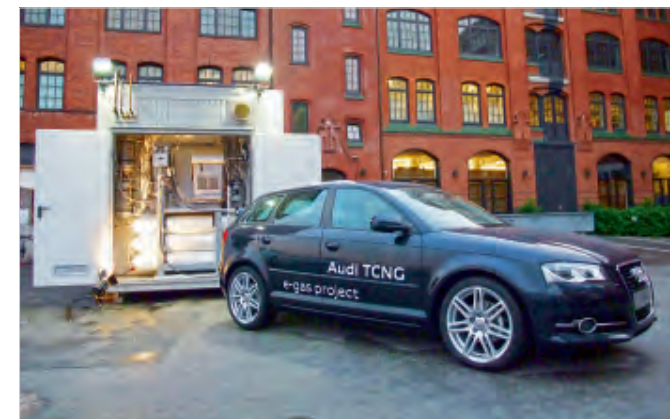
// Ein Erdgasfahrzeug der Audi AG wird an der 25-kW-„Power-to-Gas“-Anlage betankt. // A natural gas vehicle by Audi AG being refuelled at the 25-kW “Power-to-Gas” plant.
