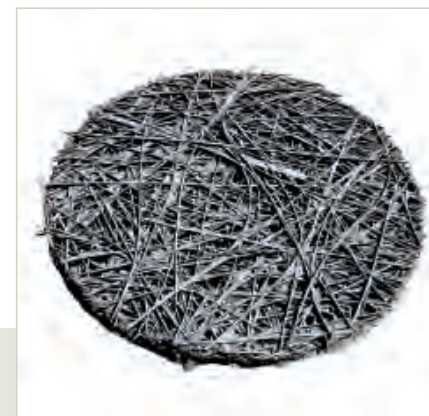
// Ermittlung von Morphologie und Oberflächeneigenschaften mittels \mu -CT. // Determination of the morphology and surface properties using \mu -CT.
