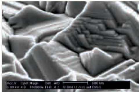
// Nasschemische Abscheidung von ZnS-Schichten auf die CIGS-Schicht mit unterschiedlichen Beschichtungsparametern: Das Bild zeigt die Verbesserung von einer schlechten zu einer guten Schichtbedeckung.
