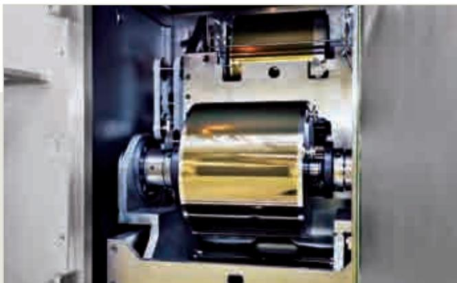
// Blick in die Aufrollkammer der Rolle-zu-Rolle-Anlage am ZSW.
