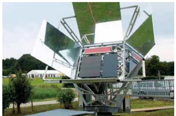
// Solar-Tracker mit dreifacher Konzentration auf dem Solar-Testfeld Widderstall // Solar tracker with threefold concentration at the Widderstall solar testing facility
