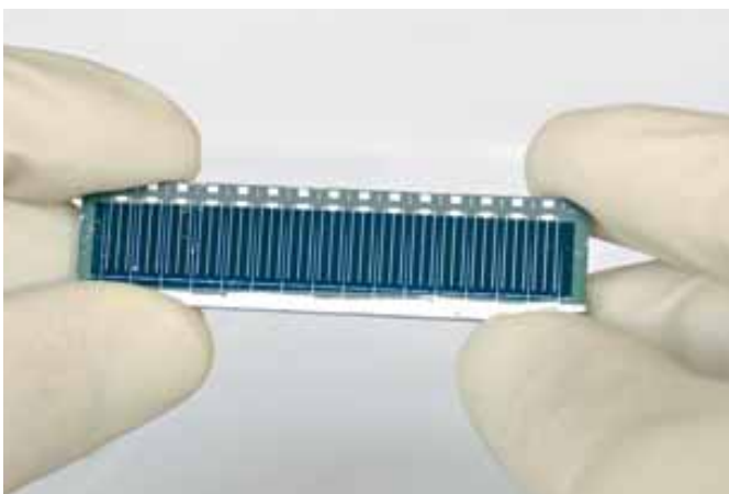
// Teststreifen mit CIGS-Rekordzelle aus der Durchlaufanlage des ZSW // Test strip with CIGS record cell produced in the ZSW inline plant
