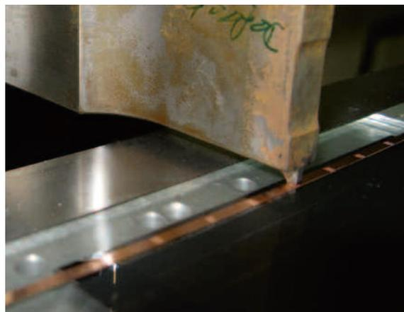
*Ultraschall-Schweißen eines metallischen Kontaktbändchens auf ein Dünnschicht-Solarmodul*
