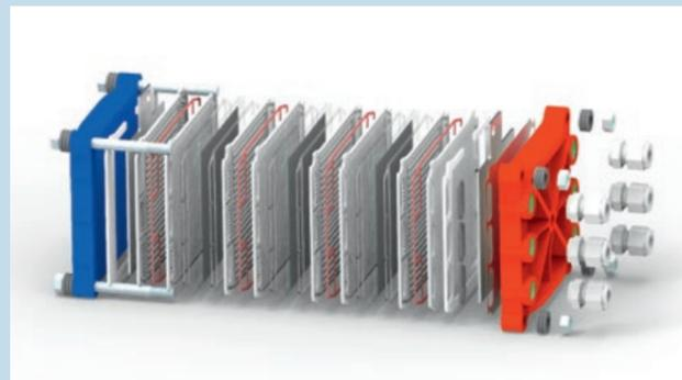
// Brennstoffzellenforschung: Bau eines Stacks im Fahrzeugdesign (links) sowie CAD-Brennstoffzellenstack im Forschungsdesign (oben).
