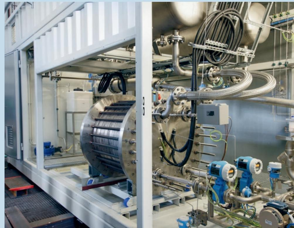
// Betriebsfertiger 20-zelliger Elektrolyse-Versuchsblock mit ca. 105 kW.
