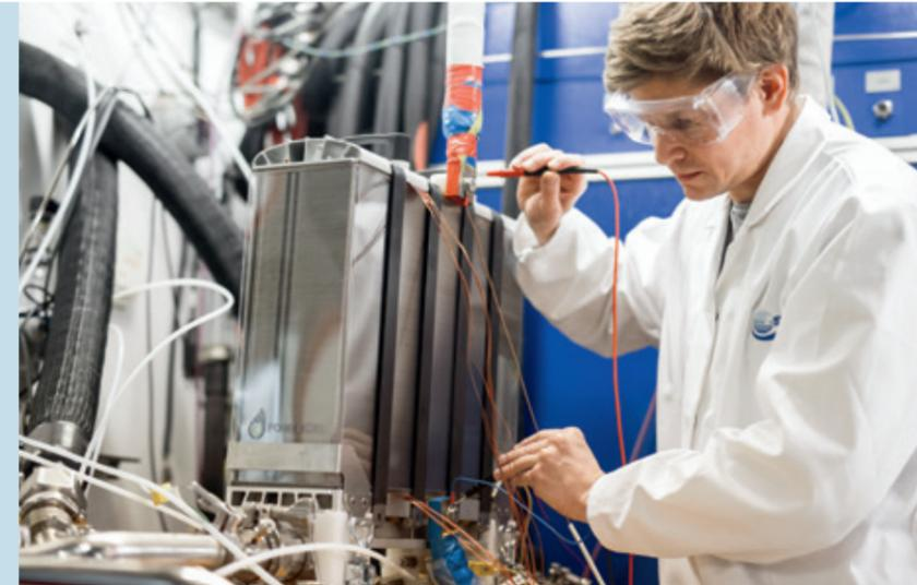
// 100-kW-Brennstoffzellenstack für den Fahrzeugantrieb.
