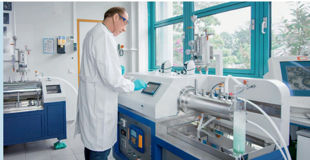
// Synthesereaktoren am ZSW zur Herstellung von bis zu 30 Kilogramm Aktivmaterial.
