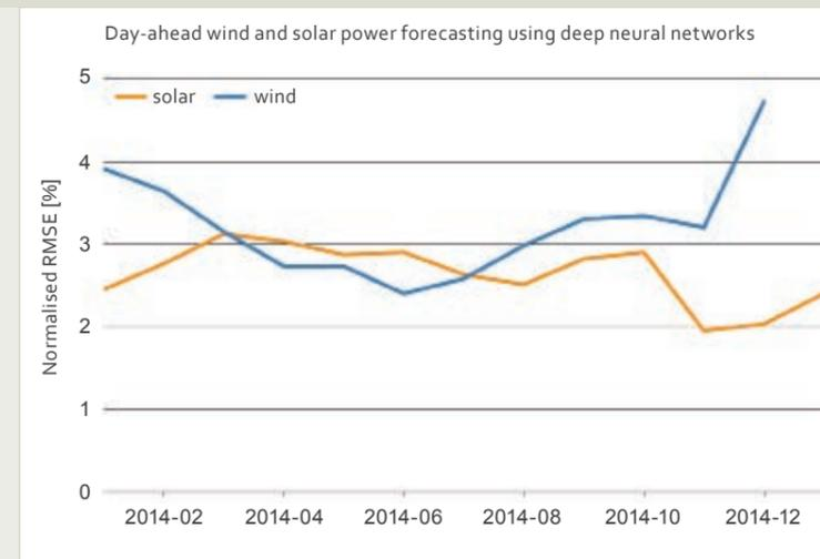
// Mittlerer quadratischer Fehler normiert auf die installierte Leistung (nRMSE) für Day-ahead-Wind- und -PV-Prognosen für Deutschland im Jahr 2014. Der Vorhersagefehler für die Windleistungsprognose konnte auf 3,4% im Jahresmittel gesenkt werden. Ende des Jahres zeigte sich ein besonders turbulentes Wettergeschehen.
