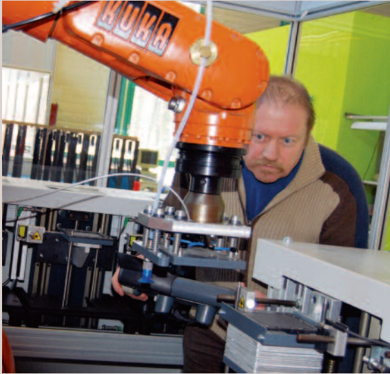
Roboterunterstützte Montage einer ZSW-Brennstoffzelle Robotic-supported assembly of a ZSW fuel cell
