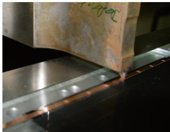
Ultraschall-Schweißen eines metallischen Kontaktbändchens auf ein Dünnschicht-Solarmodul
