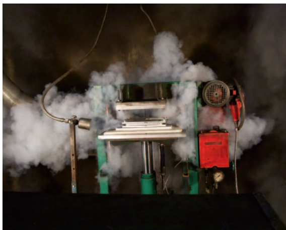
Rauchemission bei Nagel-Penetrationstest für eine Li-Zelle für die EV-Applikation
