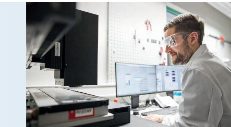
// Qualitätssicherung der Gasverteilerstrukturen mittels Weißlichtinterferometer.
