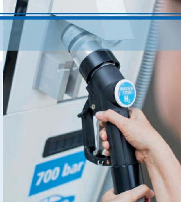
// Die Betankung von Brennstoffzellenautos mit H<sub>2</sub> erfolgt über Druckgas an Wasserstofftankstellen.
