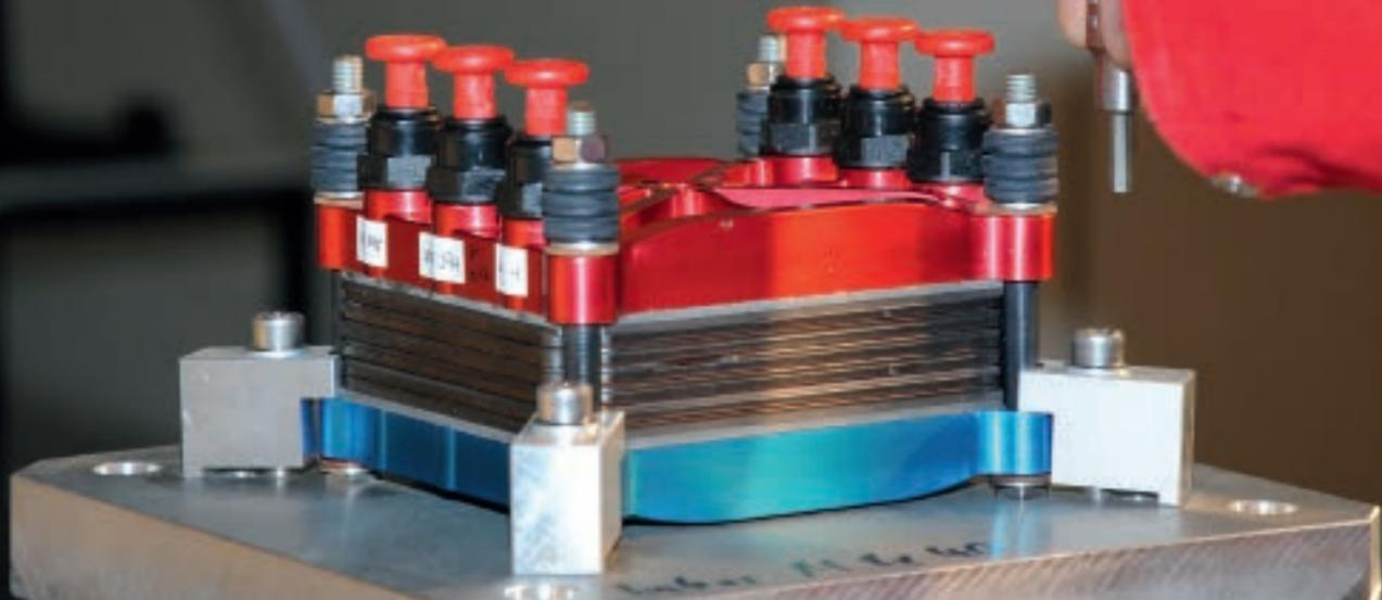
// Brennstoffzellenstack auf dem Vibrations- und Schockprüfstand.
