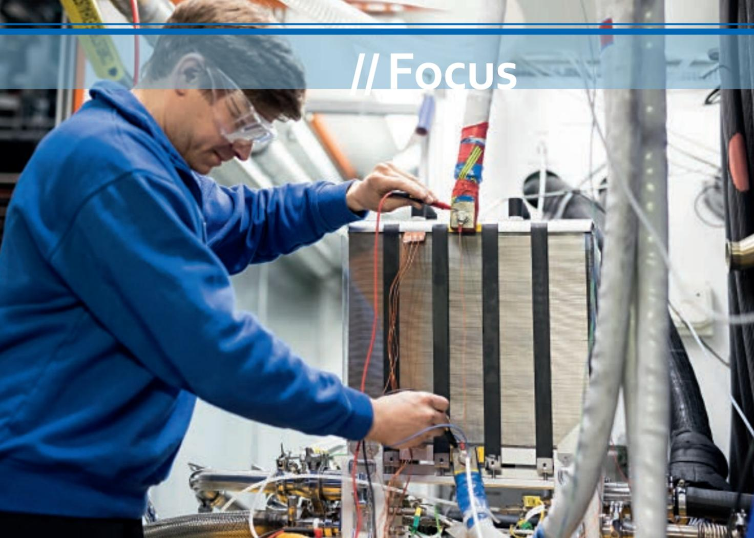
// Fahrzeugtaugliche Hochleistungsbrennstoffzelle mit 100-kW-Dauerleistung im ZSW-Teststand.
