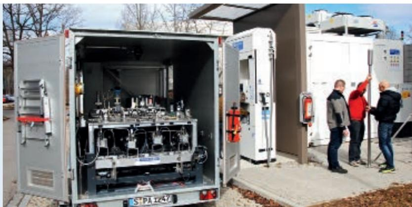
// Mobiles Messsystem zur Abnahme von H<sub>2</sub>-Tankstellen.
