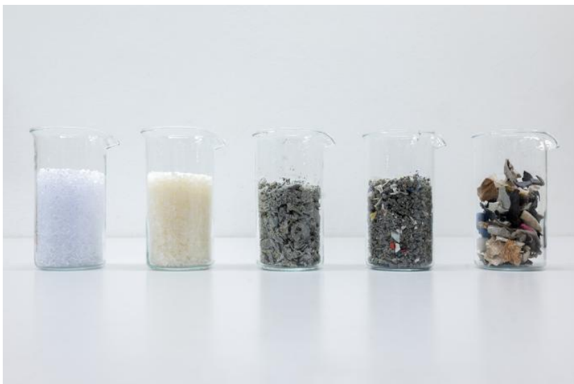
Beispielhafte Verarbeitungs- und Produktionsreste, Rein- und Rezyklat-Kunststoffe als Einsatzmaterialien für die thermochemische Behandlung im Thermolyseprozess.
