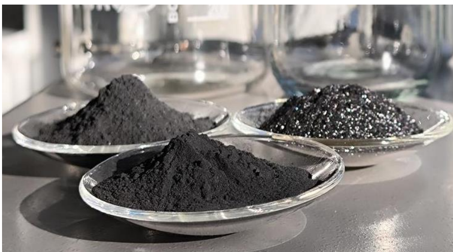
Graphitpulver aus der Graphitisierungsbehandlung im Labormaßstab zum weiteren Einsatz in Batteriezellen und für elektrochemische Tests.
