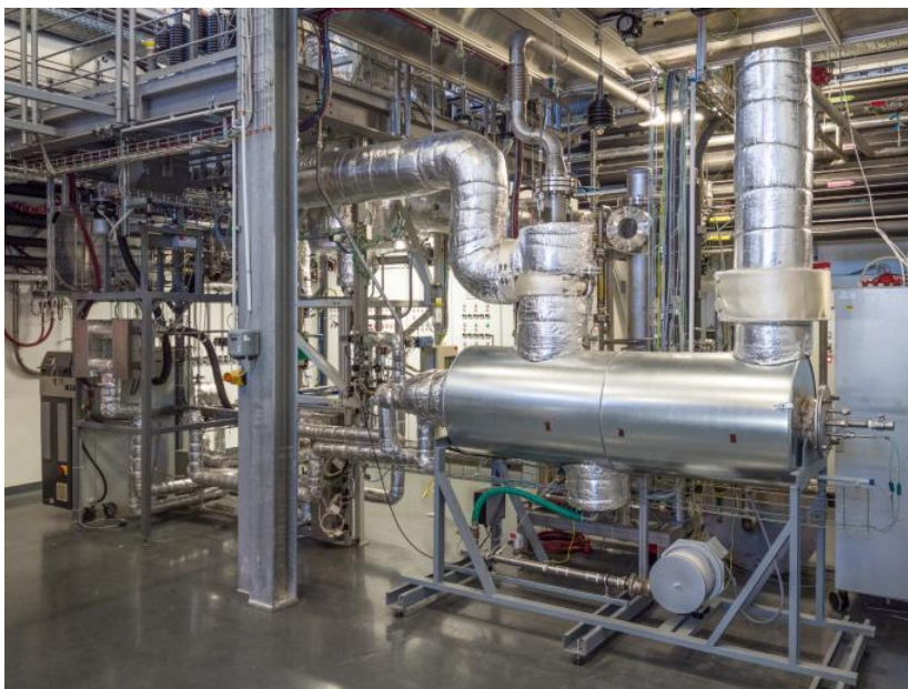
Hochtemperatur-Testumgebung zur Prozessentwicklung im Technikum des ZSW mit Abgasnachbehandlung, verschiedenen Probenahmesystemen und umfangreicher Messtechnik.
