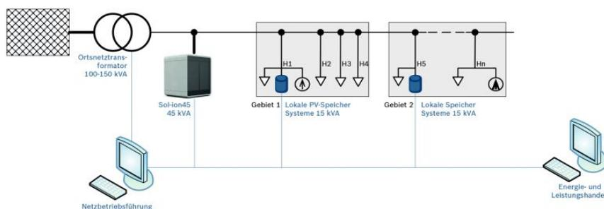
Schematischer Aufbau Feldtest Sol-ion+.
