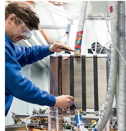
Automotive BZ-Stack 100 kW (Bild: ZSW)
