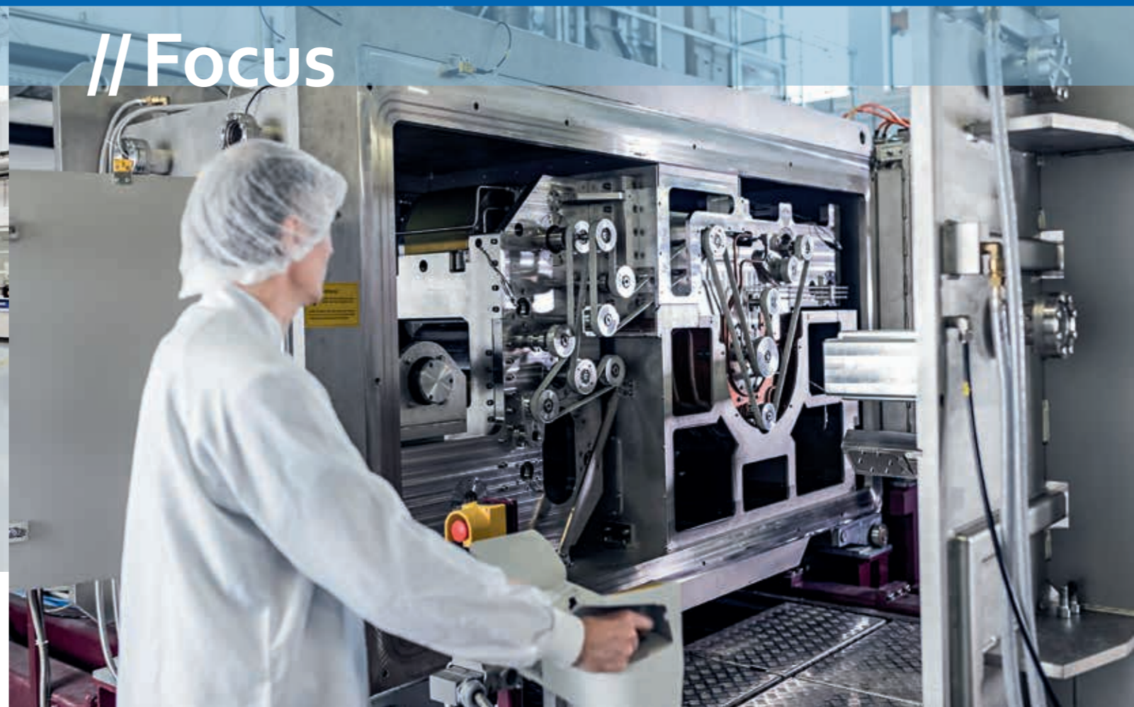
// Anlage zur Rolle-zu-Rolle-Beschichtung von flexiblen Substraten am ZSW. // System for roll-to-roll coating of flexible substrates at ZSW.
