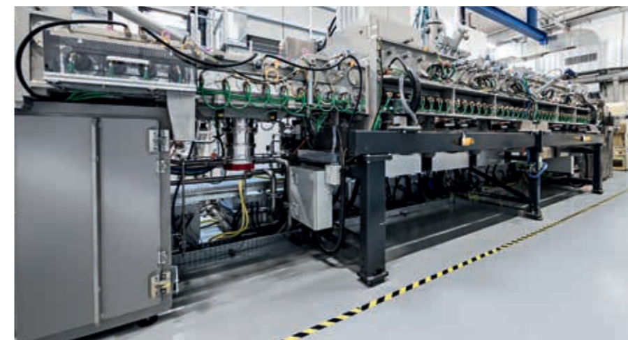
// Neue Inline-Beschichtungsanlage für CIGS-Dünnschichtsolarmodule auf Glas im Format 30 x 30 cm 2 . // New inline coating plant for CIGS thin-film solar modules in sizes up to 30 x 30 cm 2 .
