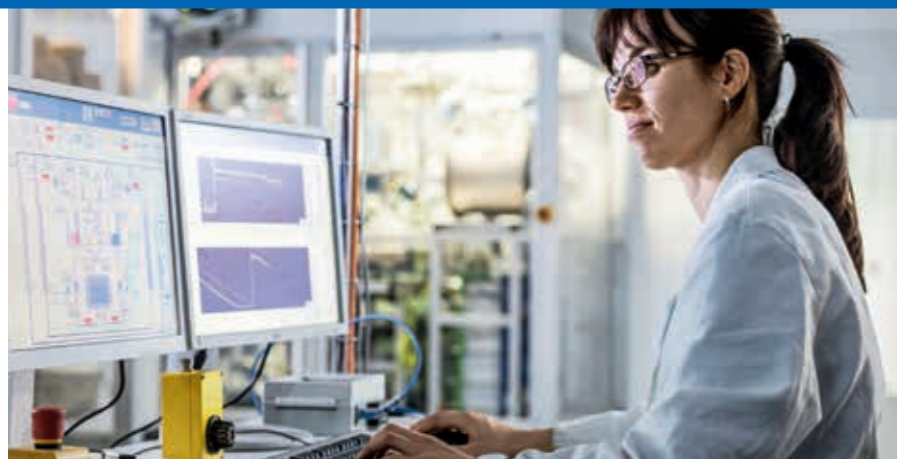
// Elektrolyse-Versuchsbetrieb zur Charakterisierung von drucklosen Elektrolyseblöcken bis 10 kW und von Systemkomponenten. // Electrolysis test operation for the characterisation of unpressurized electrolysis blocks up to 10 kW and of system components.
