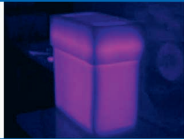
// Oberflächentemperatur des Autoklav ohne (links) und mit (rechts) thermischer Isolierung. // Surface temperature of the autoclave without (left) and with (right) thermal insulation.
